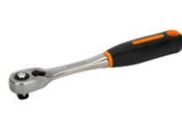
Roquete reversível 3/8". 72 dentes/5° de ângulo de ação. Cabeça esguia para espaços estreitos 7750SL
