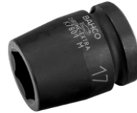
Kraftpipe med 1/2" firkantinnfestning, 13 mm sekskant og fosfatert utførelse K7801M-13
