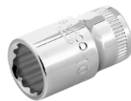
Pipe med 1/4" firkantinnfestning og 11 mm tolvkantprofil A6700DM-11
