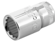
Pipe med 1/4" firkantinnfestning og 5,5 mm tolvkantprofil A6700DM-5.5
