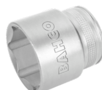
Chiave attacco quadro 1/2" con profilo esagonale da 17 mm e finitura lucida 7800SM-17
