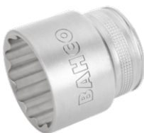
Chiave a bussola attacco quadro 1/2" con profilo doppio esagono da 19 mm 7800DM-19
