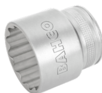
Chiave a bussola attacco quadro 1/2" con profilo doppio esagono da 32 mm 7800DM-32
