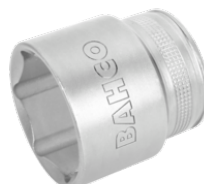
Vaso con cuadrado de 1/2" con perfil hexagonal de 33 mm y acabado pulido fino 7800SM-33
