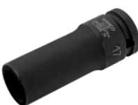
Vaso de impacto de serie larga con cuadradillo de 1/2" con perfil hexagonal de 14 mm y acabado fosfatado K7806M-14
