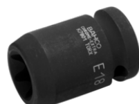
Vaso de impacto con cuadradillo de 1/2" con perfil de cabeza E16 TORX® y acabado fosfatado K7801TORX-E16
