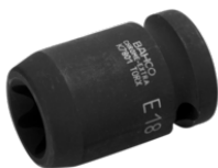
Vaso de impacto con cuadradillo de 1/2" con perfil de cabeza E10 TORX® y acabado fosfatado K7801TORX-E10
