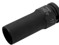
Vaso de impacto de serie larga con cuadradillo de 1/2" con perfil hexagonal de 27 mm y acabado fosfatado K7806M-27
