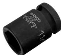
Vaso de impacto con cuadradillo de 1/2" con perfil hexagonal de 5/8" y acabado fosfatado K7801Z-5/8
