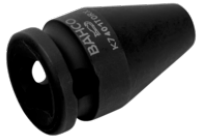
Vaso de impacto con cuadradillo de 3/8" con perfil de cabeza E10 TORX® y acabado fosfatado K7401TORX-E10
