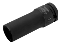
Vaso de impacto de serie larga con cuadradillo de 1/2" con perfil hexagonal de 16 mm y acabado fosfatado K7806M-16
