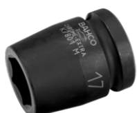
Vaso de impacto con cuadradillo de 1/2" con perfil hexagonal de 22 mm y acabado fosfatado K7801M-22
