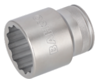
Vaso con cuadradillo de 3/4" con perfil bi-hexagonal de 33 mm 8900DM-33
