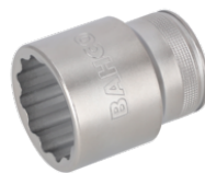
Vaso con cuadradillo de 3/4" con perfil bi-hexagonal de 34 mm 8900DM-34
