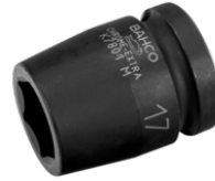
Vaso de impacto con cuadradillo de 1/2" con perfil hexagonal de 13 mm y acabado fosfatado K7801M-13
