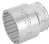
Standardně dlouhé nástrčné klíče, 1/2" čtvercový nástavec. metrický dvanáctihřanný profil 7800DM-18
